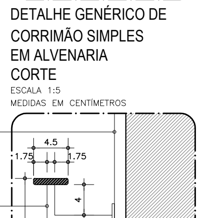
DETALHE GERAL DE CORRIMÃO SIMPLES EM ALVENARIA CORTE ESCALA 1:5 MEDIDAS EM CENTÍMETROS
