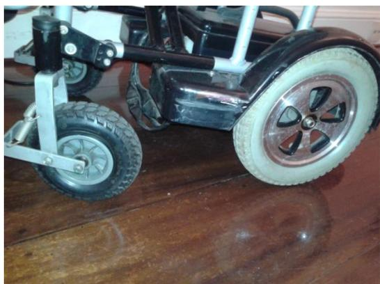
Troca dos pneus dianteiros da cadeira motorizada devido ao desgaste e ressecamento.
