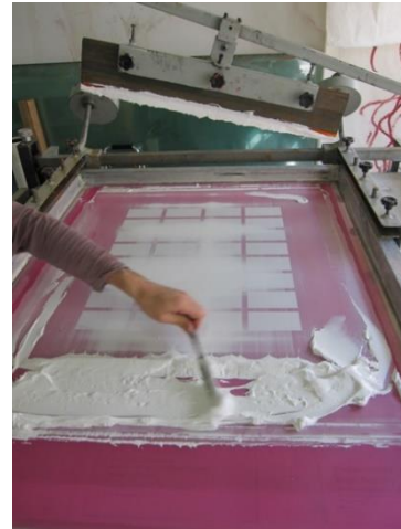
Impressão em serigrafia dos módulos que compõem os painéis.
